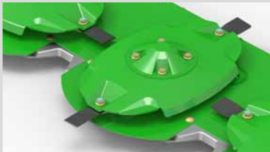
SYSTÈME DE REMPLACEMENT RAPIDE DES COUTEAUX
