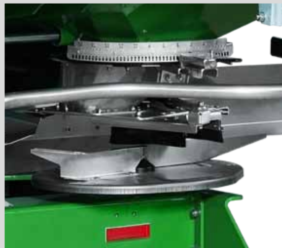
SYSTÈME DE SEMIS AVEC ÉCHELLE VISIBLE ET BROSSES
